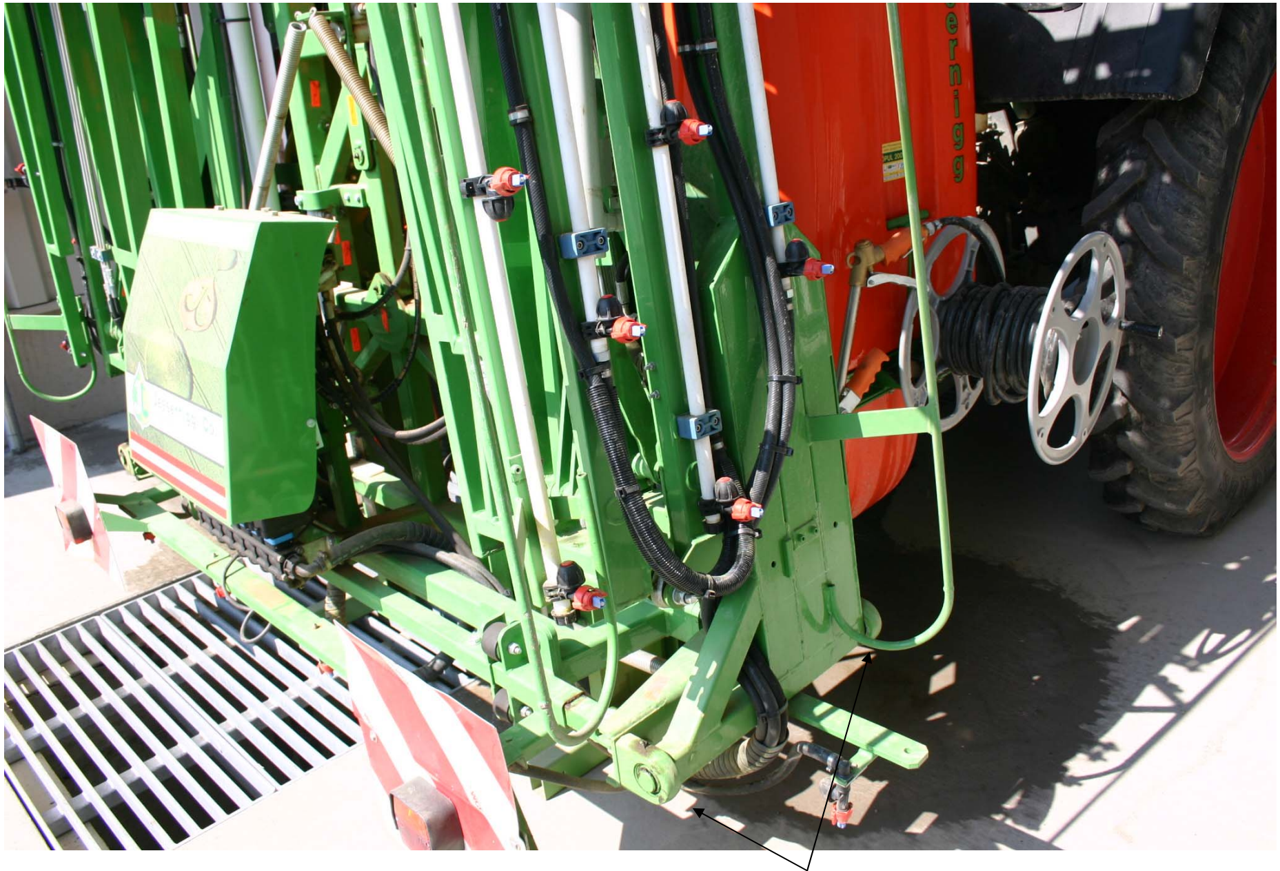
extrem breites Gelenk mit einstellbaren Kugelgelenksköpfe servicefreundlich und außergewöhnlich langer Hebel zur Kraftaufnahme
