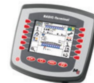
**Alle Computersteuerungen ermöglichen u.a. die geschwindigkeitsabhängige Regelung der Ausbringung einer vorher festgelegten Spritzmittelmenge in Liter/Hektar durch einen bestimmten Düsentyp.**
