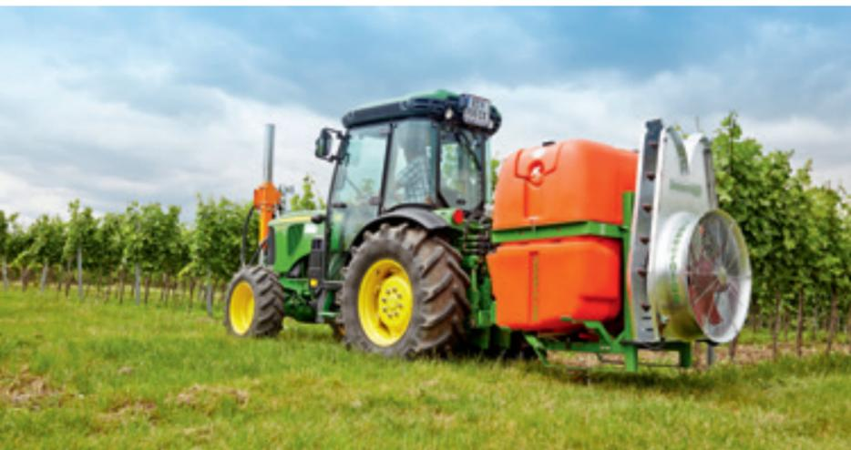
Das wahlweise erhältliche, leistungsstarke 700 mm Aufsatzgebläse (verzinkt) mit 12 abdriftarmen Doppelflachstrahldüsen sichert auch bei hoch gewachsenen Pflanzen einen beidseitigen homogenen Wirkstoffbelag in hoher Qualität.
