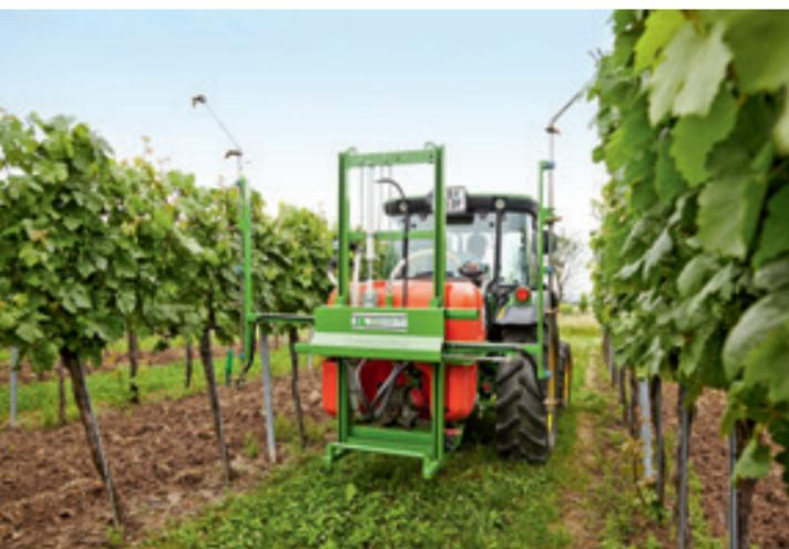
Unabhängig von Fahrzeilenbreite und Wuchshöhe der Reben können die speziellen Doppelflachstrahldüsen am hydraulisch höhen- und breitenverstellbaren Spritzgestänge sehr nahe an die Pflanze gebracht werden. Damit ist gewährleistet, dass das Spritzmittel zielsicher, präzise und dank des Schrägstrahls auch auf der Blattrückseite appliziert wird.
