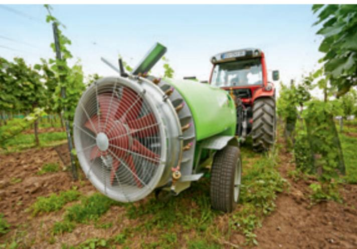
Der kräftige, nahezu drallfreie Trägerluftstrom des leistungsstarken 820 mm Axialgebläses sichert eine hohe Applikationsqualität. Das Sprühmittel wird von der trockenlaufsicheren Pumpe zu 15 verstellbaren, einzeln absperzbaren, abdriftarmen Doppelschwenkdüsen mit Nachtropfstopp gepumpt, präzise zerstäubt und sicher appliziert.
