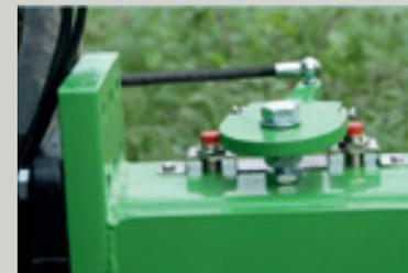
Auf der äußerst spurtreuen, mechanischen Lenkdeichsel (Serienausstattung) sitzt die leistungsstarke Kolben-Membran-Pumpe. Sie ist vor dem Drehpunkt der Deichsel montiert, daher entsteht beim Kurvenfahren kein Winkel im Gelenk der Zapfwelle. Das schont das Gelenk und erhöht die Lebensdauer aller Teile.
