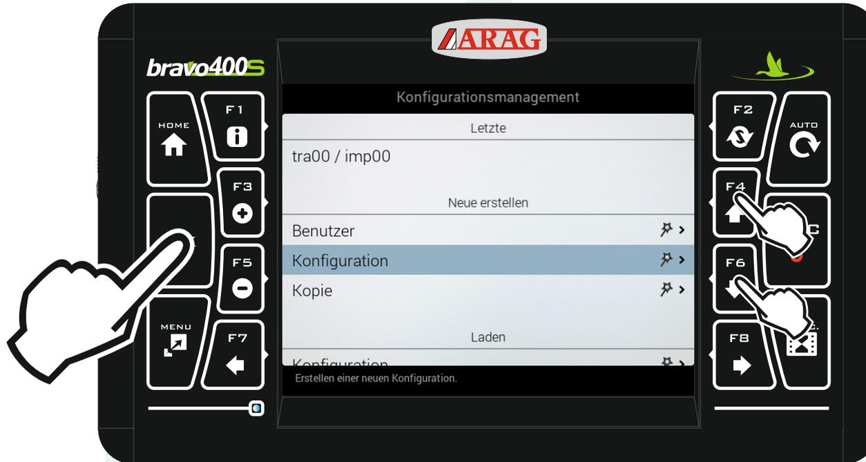
mit den Pfeiltasten „F4“ und „F6“ die Zeile „Konfiguration“ unter der Überschrift „Neue erstellen“ markieren und „Ok“ drücken.
