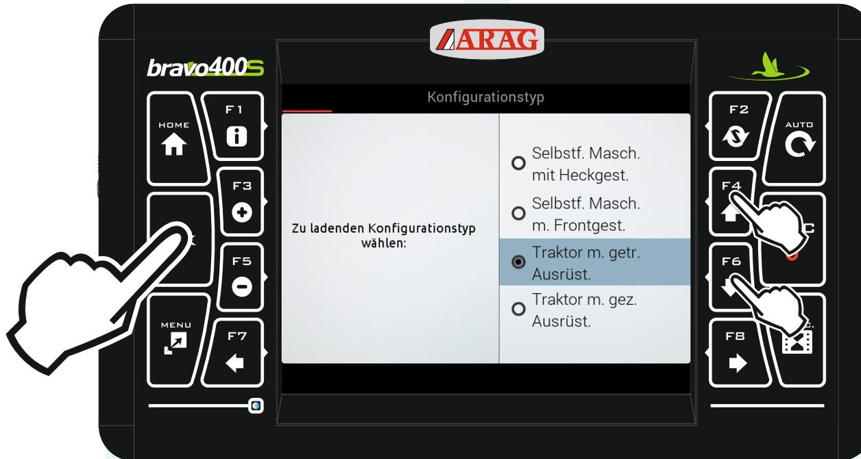
mit den Pfeiltasten „F4“ und „F6“ „Traktor m. getr. Ausrüst.“ markieren und „Ok“ drücken.
