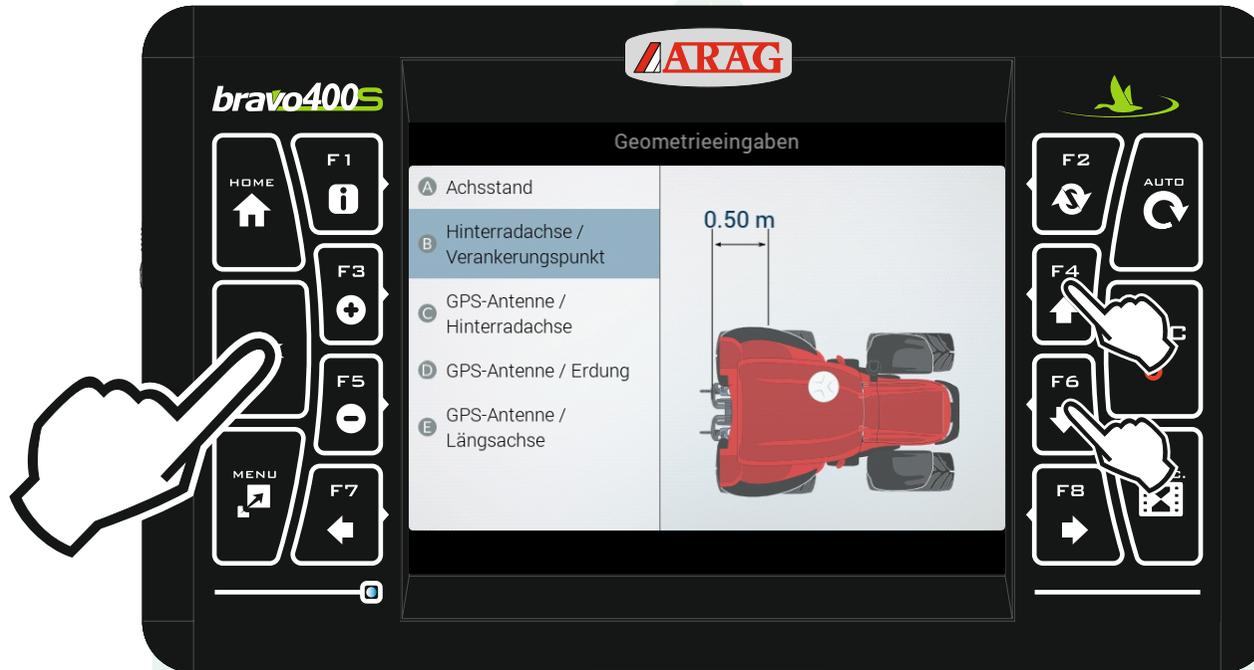
Genau so wie beim Achsstand mit den Pfeiltasten „F4“ und „F8“ „Hinterachse / Verankerungspunkt“ auswählen „Ok“ drücken und den Wert entsprechend ändern.
