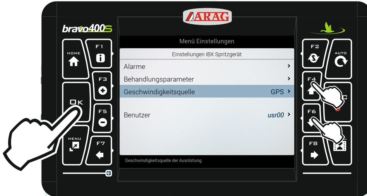
Mit den Pfeiltasten „F4“ und „F6“ die Zeile „Geschwindigkeitsquelle“ markieren und „Ok“ drücken.
