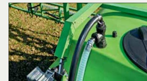
*In einem über dem Behältersystem liegenden Kabelkanal sind die Versorgungskabel für die Maschinensteuerung sicher und gut zugänglich verlegt.*
